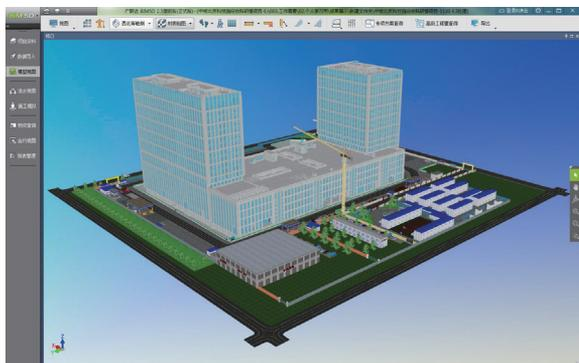
集成土建、机电、钢构、幕墙等多专业信息模型，承接 Revit、MagiCAD、Tekla 等国际主流建模软件，无缝对接广联达 BIM 算量系列软件。
