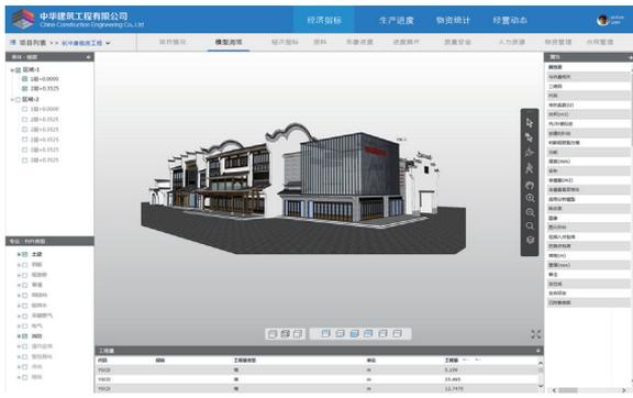
从单体、楼层、专业、系统等多个维度在线过滤浏览模型，并能查询具体图元的属性和工程量。
